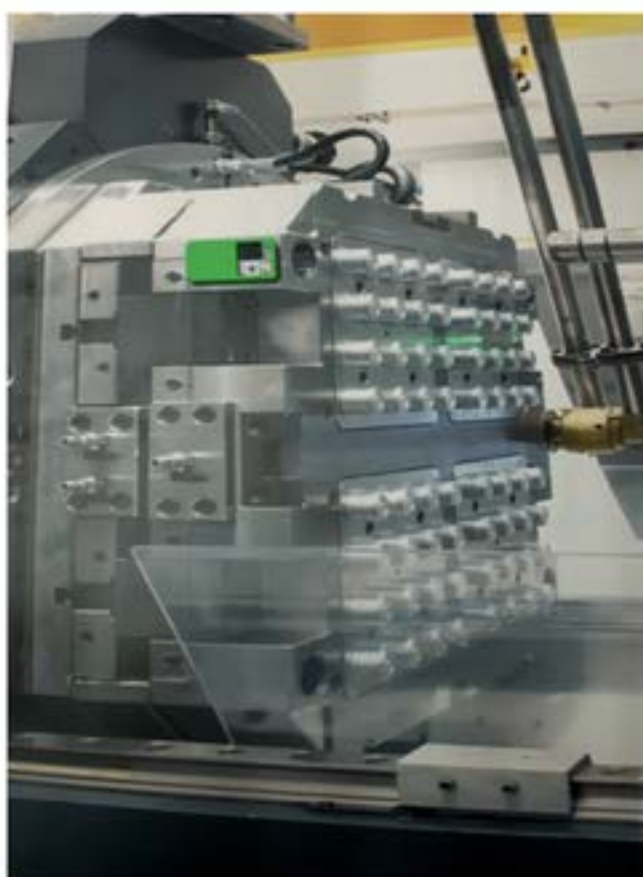
Il Il sensore TMOLD applicato su uno stampo.
